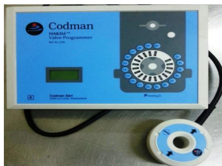
Figure 1 .HAKIM valve programmer (Medos)
